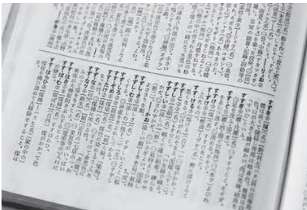
5.5ポイント明朝漢字(ベントン彫刻機で母型を新刻)を活字組版し、写真縮小による製版を経ずに印刷した『明解国語辞典』(三省堂、1943年5月10日初版)。印刷は三省堂蒲田工場。写真上は紙面をスキャンしたものの
