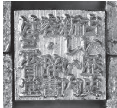
上左：右の原図からパターンを製版し、母型を彫刻したうえで鋳造された活字（1号サイズ。27.5ポイント=9.66mm角）
